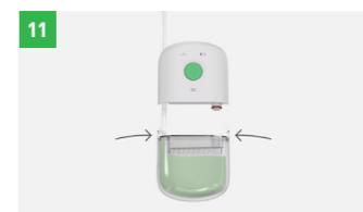
Rimuovere il canister premendo i pulsanti a molla su entrambi i lati e tirando. Sostituire il canister scollegato con uno nuovo spingendo il contenitore finché non scatta su entrambi i lati e si blocca in posizione.
